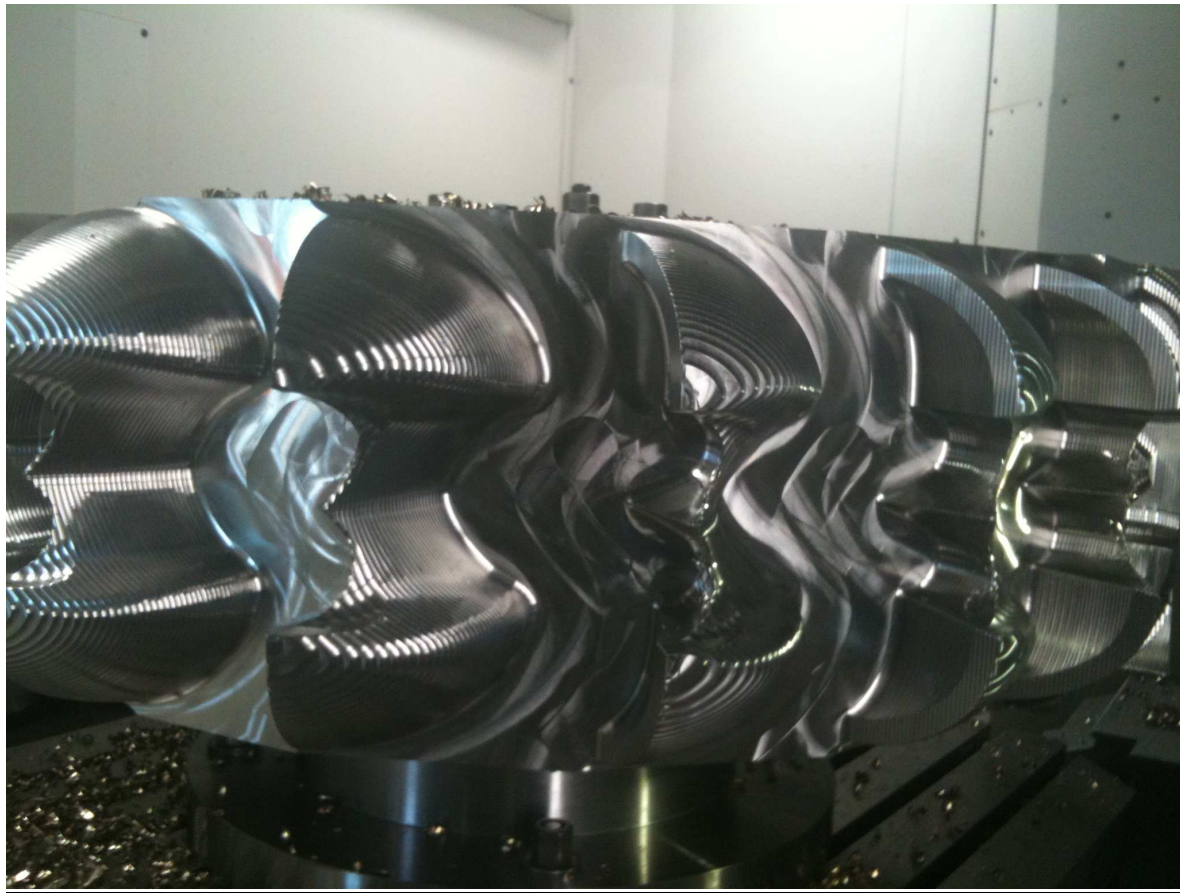
Fotos Peltonlaufrad aus dem Vollen gefräst, aktuelles Beispiel 3.2 MW 3-düsige horizontale PTH, vom Samstag, 07.05.2011
